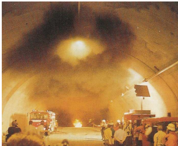
1. ábra: Ellenőrzött, kísérleti tűz az Engelberg bázisalagútban (1999. 07. 17.)
